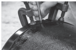
図62 タッピンねじの締め付け
