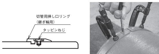
図93 タッピンねじの締め付け
