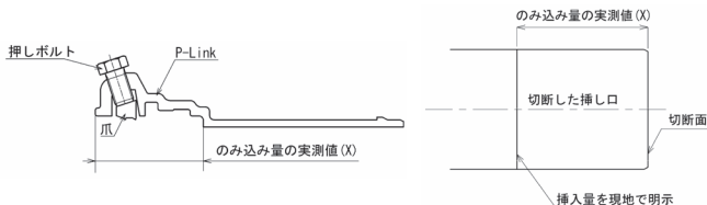
図56 挿し口の挿入量 (X)
