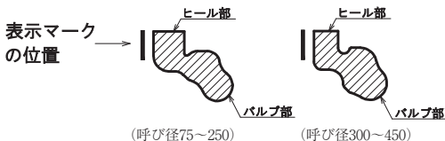
図11 ゴム輪(直管用)の表示マーク位置
