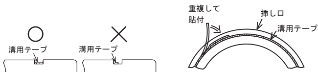
図76 溝用テープ貼り付け方法
