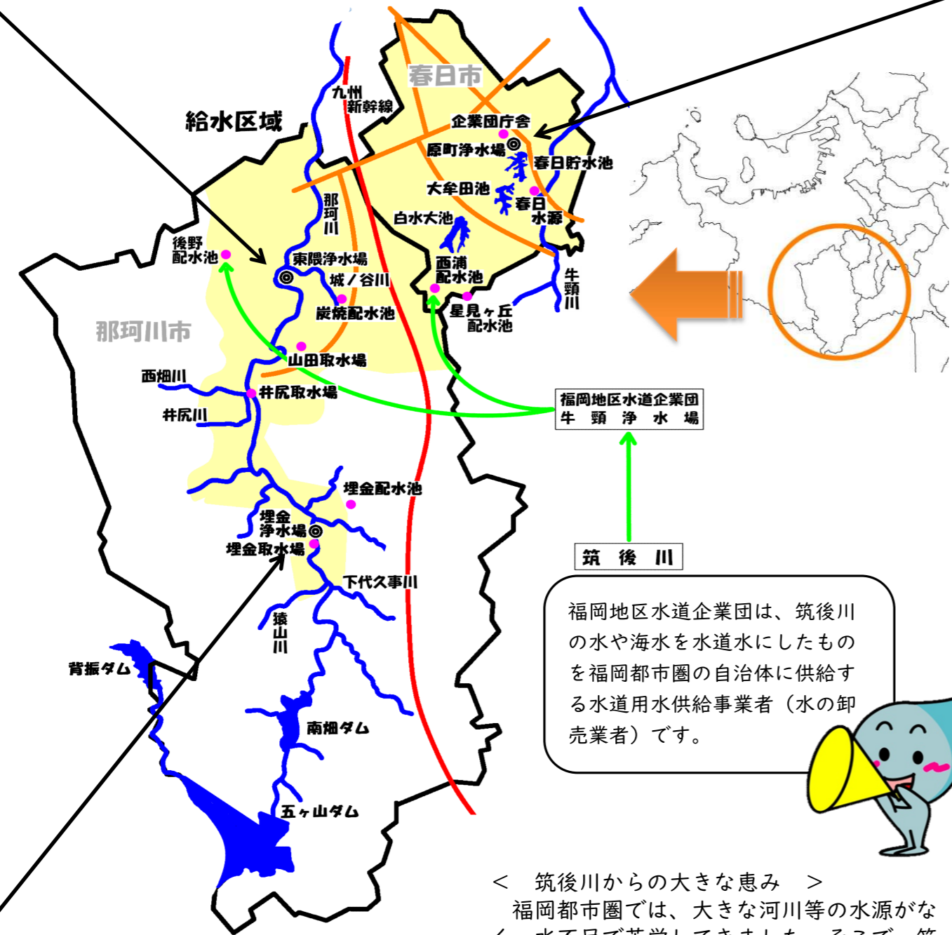
【東隈浄水場】 施設能力：22,000m 3 /日 処理方式：粉末活性炭+膜ろ過方式
