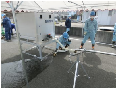
↑ 応急給水訓練の様子です。給水車の操作確認、パネル式給水タンクの組立て等を行いました。
